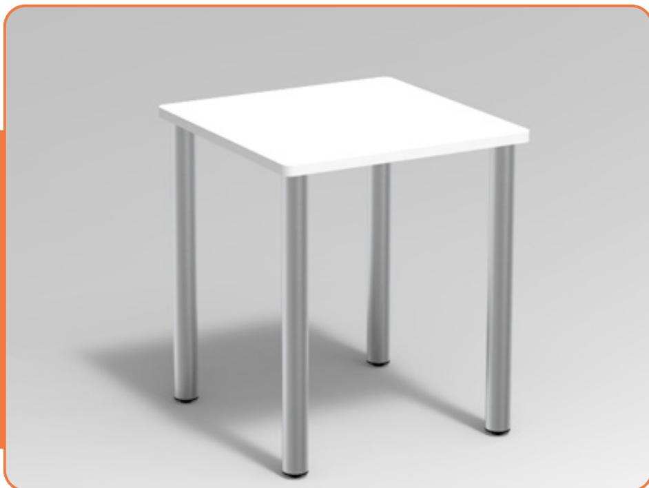
Banco con struttura fissa e piano in nobilitato di spessore 25mm bordato ABS 2mm. Piano fissato alla struttura con quattro fissaggi alle traverse perimetrali aventi misura 40x20mm. Dotato di piedini in gomma antirumore. ARTICOLO CONFORME AI CAM E ALLA NORMATIVA VIGENTE E REALIZZATO CON MATERIALI CERTIFICATI FSC E PEFC
